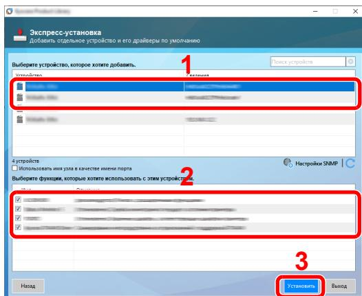
Также можно выбрать параметр [**Использовать имя узла в качестве имени порта**] и задать использование имени хоста стандартного порта TCP/IP. (При этом нельзя использовать USB-подключение.)
