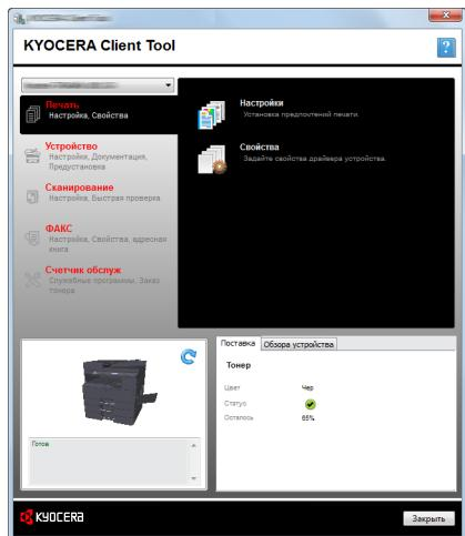
Если аппарат подключен к ПК в сети, нужно настроить "Параметры подключения" с помощью KYOCERA Client Tool. См. [Подключение аппарата к ПК в сети на стр. 2-41](#).
