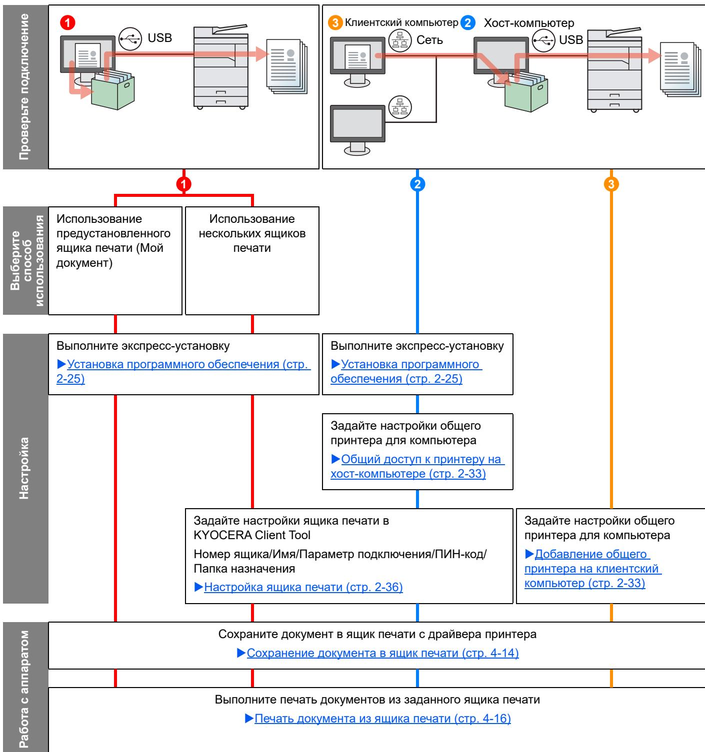
**Поток операций ящика печати в случае подключения аппарата к ПК в сети**
